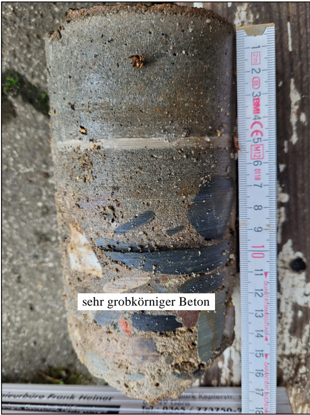
Bild 3: Rückseite Betonbohrkern aus Bild 2
