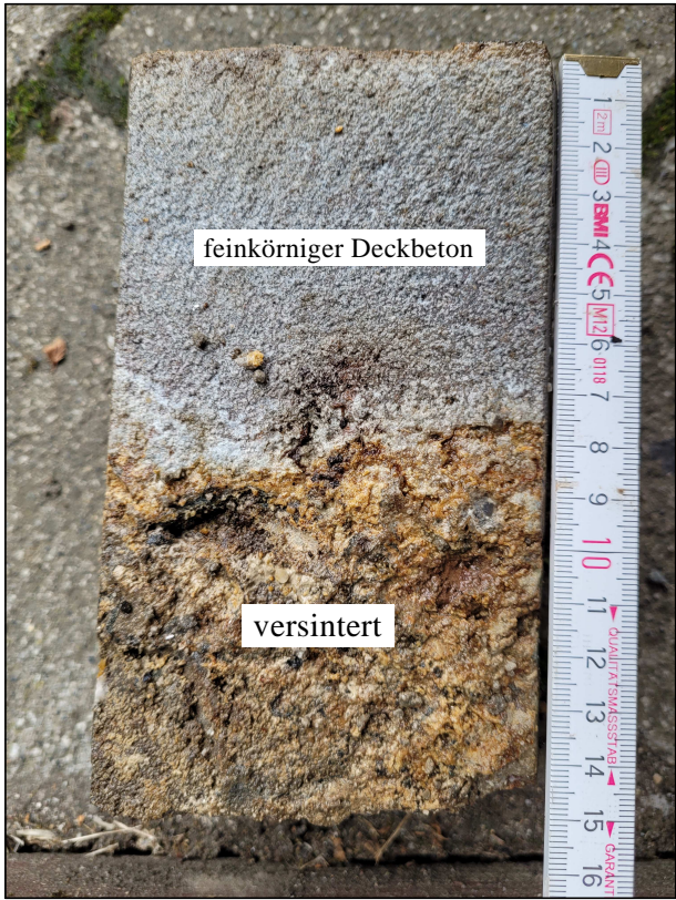
Bild 2: Betonbohrkern, gespalten
