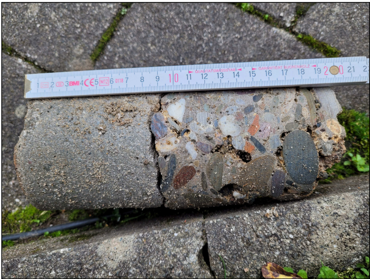
Bild 1: Betonbohrkern, abgerissen und gebrochen (Betonstärke Wehrrücken: mind. 55 cm)
